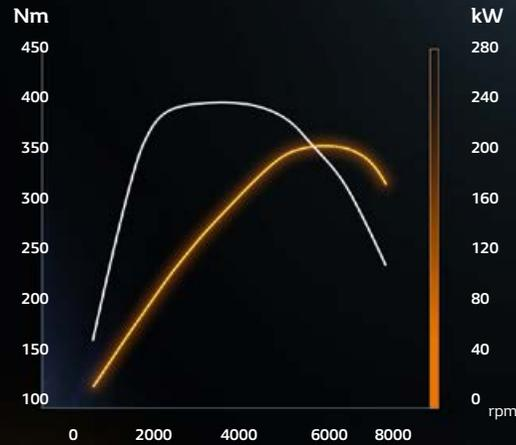
**Power: 280hp/205kw at 6,000rpm/min**
